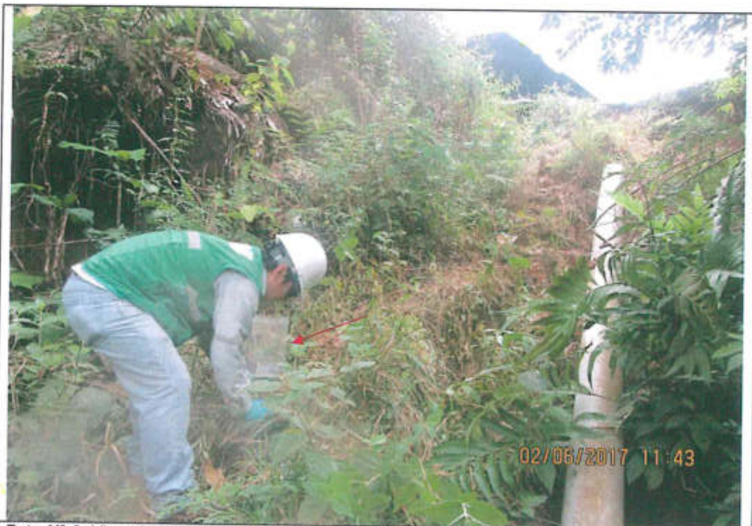
Foto N° 6. Vista de toma de muestra de suelo a 5 m aproximadamente de la salida del sistema de drenaje pluvial. Coordenadas UTM (WGS84): 341050 E / 9690030 N.
