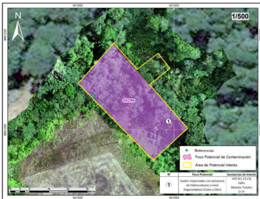
Figura 3.2. Foco potencial de contaminación en el sitio S0296
