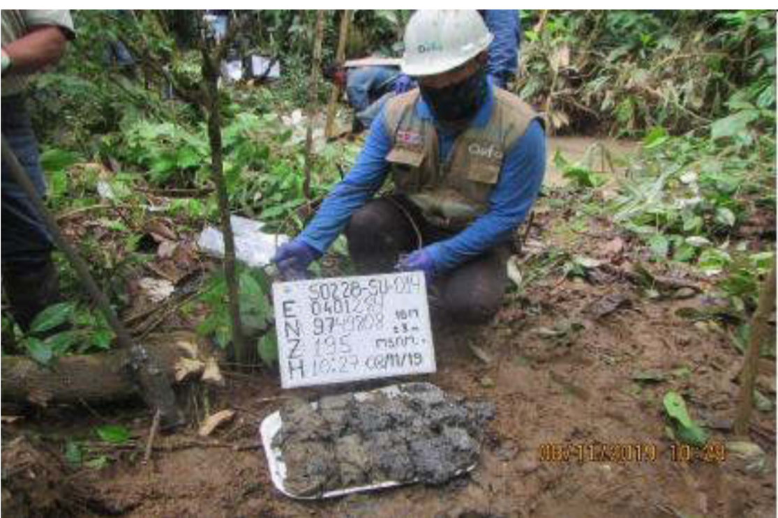
Muestra de suelo con código S0228-SU-014, donde se observa la textura arcillo limosa hasta 1,50 m de profundidad; además de una textura arenosa color gris oscuro entre 1,50 y 1,75 m de profundidad. Se registra características organolépticas a hidrocarburos (color y olor).
