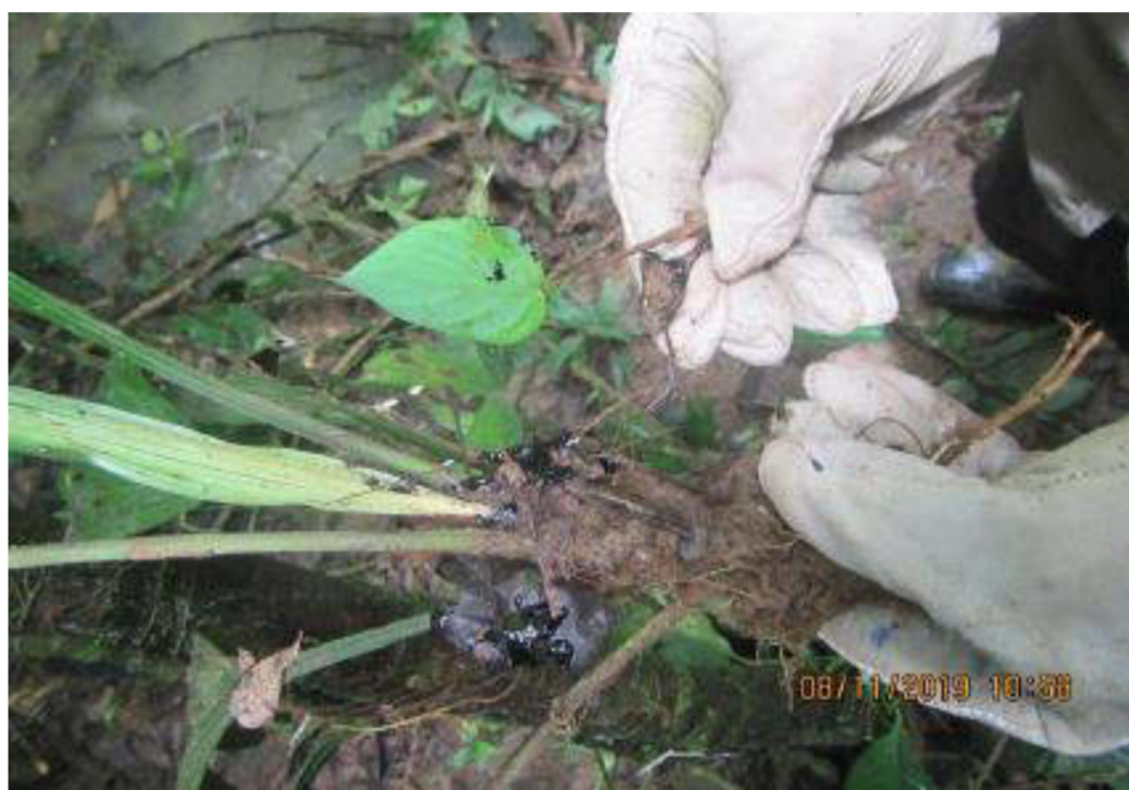
Se observó vegetación herbácea impregnada con hidrocarburo en el punto de muestreo de suelo con código S0228-SU-011.
