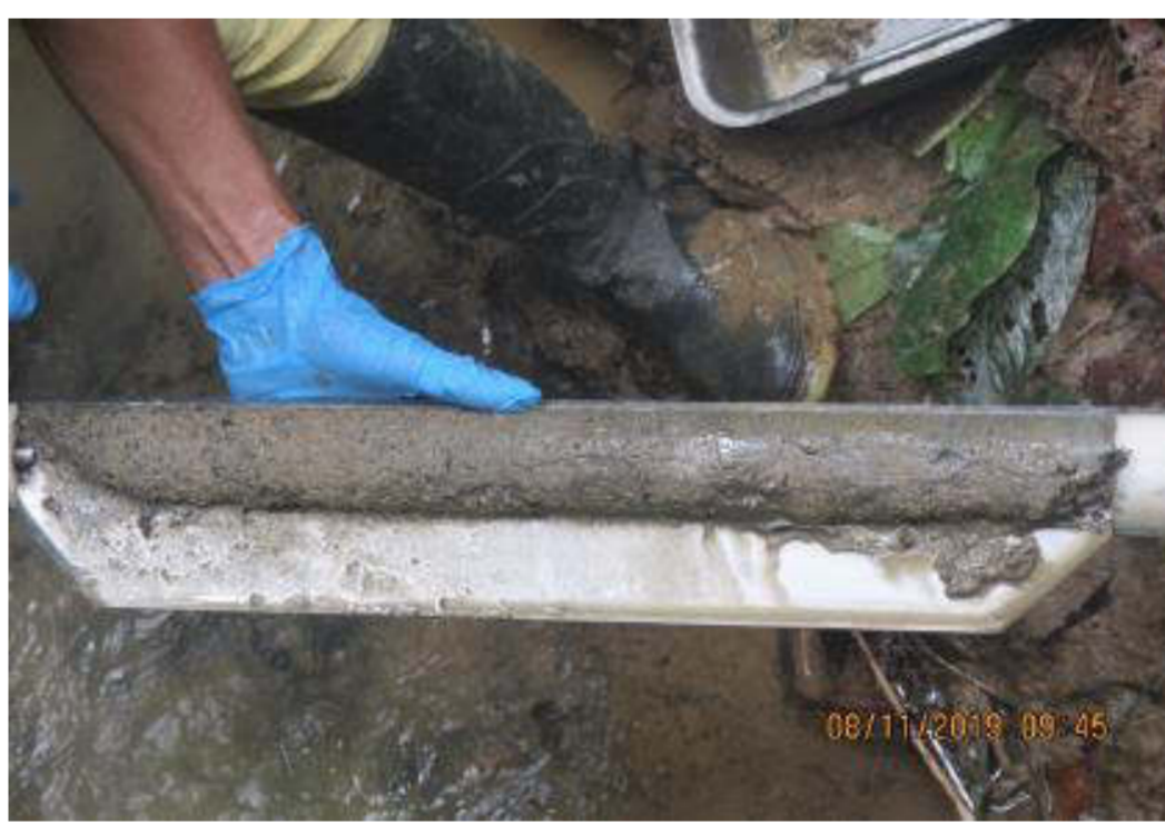
Vista de perfil de la muestra de sedimento con código S0228-SED-001, obtenido con el barreno tipo ruso hasta 0,50 m de profundidad, de textura areno limosa de color marrón grisáceo y con evidencias organolépticas a hidrocarburos (color y olor).
