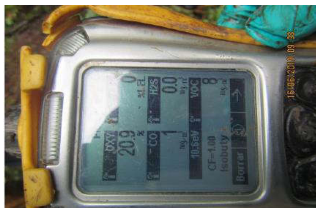
Vista de la pantalla del equipo detector de gases durante la medición de los gases generados por la muestra de suelo en el punto S0300-SU-001, en el que se registra COV=8 mg/m 3 . En este punto se registra características organolépticas debido a un ligero olor a hidrocarburos.
