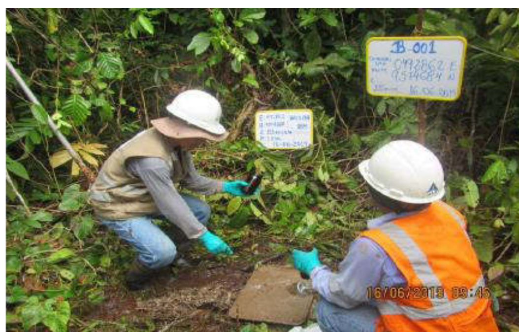
Muestreo de suelo en el punto S0300-SU-001 de los parámetros TPH F2 (C 10 -C 28 ), TPH F3 (C 28 -C 40 ) y PAHs luego de su homogenización en una bandeja de aluminio. Se observa vegetación herbácea y arbórea, con presencia de suelo mojado y arcilloso.
