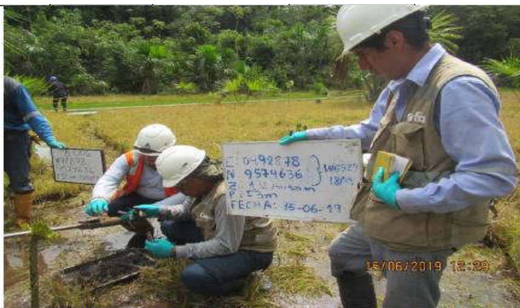
Muestreo de suelo del parámetro TPH F1 (C 6 -C 10 ) en el punto S0300-SU-006 usando el barreno. Se observa vegetación herbácea y arbórea, con presencia de suelo con agua a nivel superficial. El suelo presente presenta textura arcillosa y limosa. Se observa formación de iridiscencia durante la remoción del suelo.
