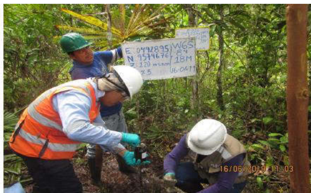
Muestreo de suelo de los parámetros TPH F2 (C 10 -C 28 ), TPH F3 (C 28 -C 40 ) y PAHs en el punto S0300-SU-002-PROF. Se observa vegetación herbácea y arbórea, con presencia de suelo mojado con textura arcillosa y arcillo arenosa.
