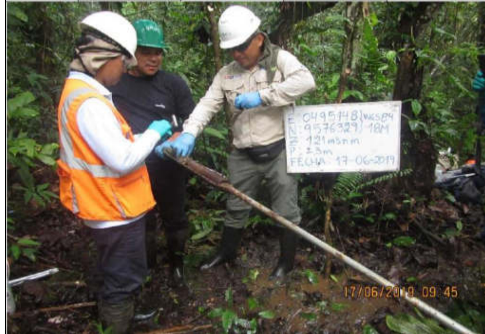
El suelo saturado presenta abundante materia orgánica hasta los 2,25 m de profundidad. El suelo contiguo presentó una textura arcillosa hasta los 2,60 m de profundidad.
