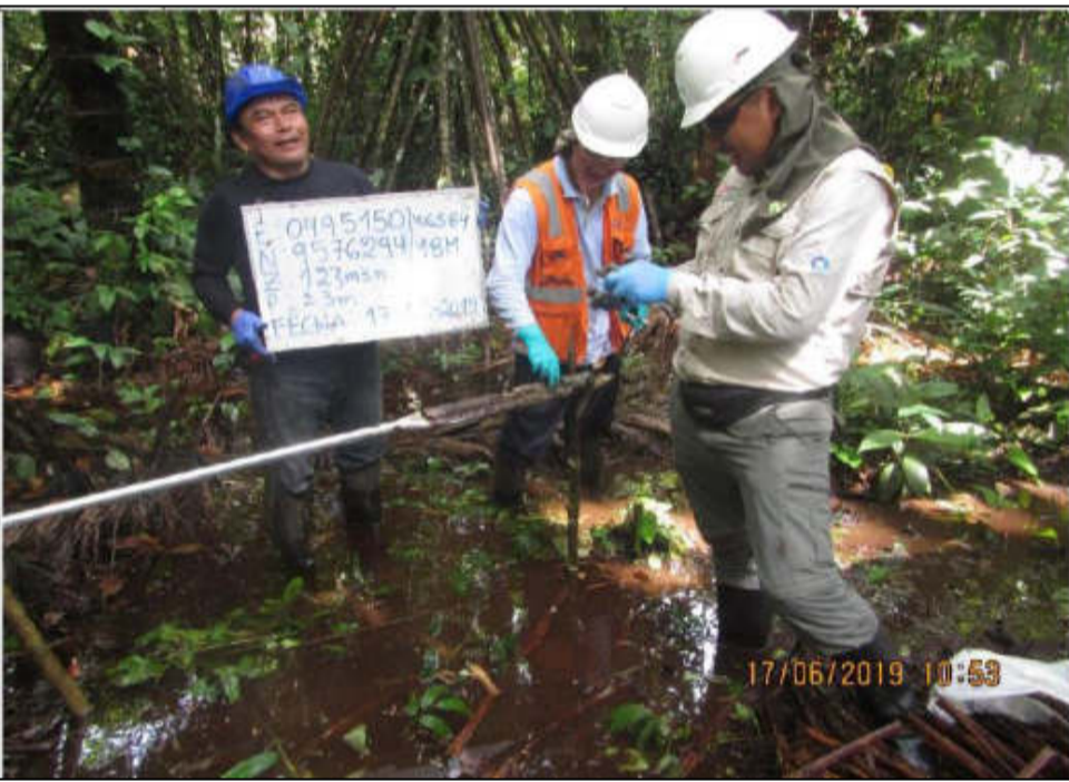
Se evidenció un nivel de agua hasta 0,20 m de profundidad así como suelo saturado con presencia de hojarasca, raíces y materia orgánica en descomposición (turba).
