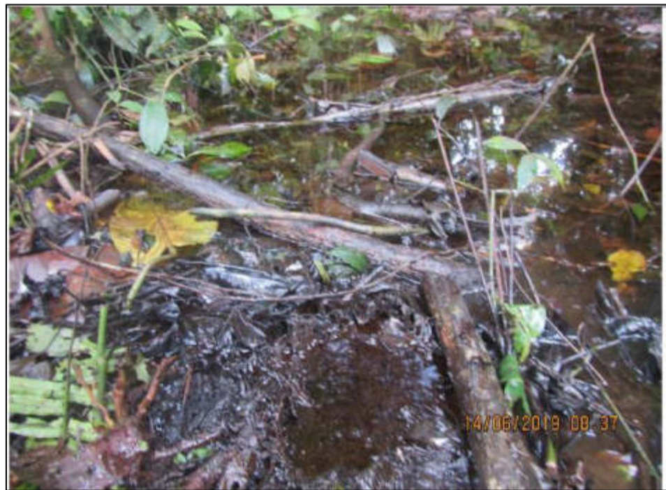
Se evidenció organolepticamente indicios de afectación por presencia de hidrocarburos (iridiscencia y manchas oleosas en el suelo saturado) durante los sondeos de muestreo.
