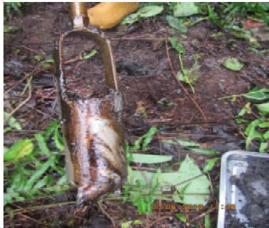
Se muestra el cabezal de barreno impregnado con hidrocarburo luego de extracción de
