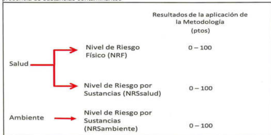
Figura 7-2. Indicadores de riesgos por presencia de peligros de tipo físico y por presencia de sustancias contaminantes
