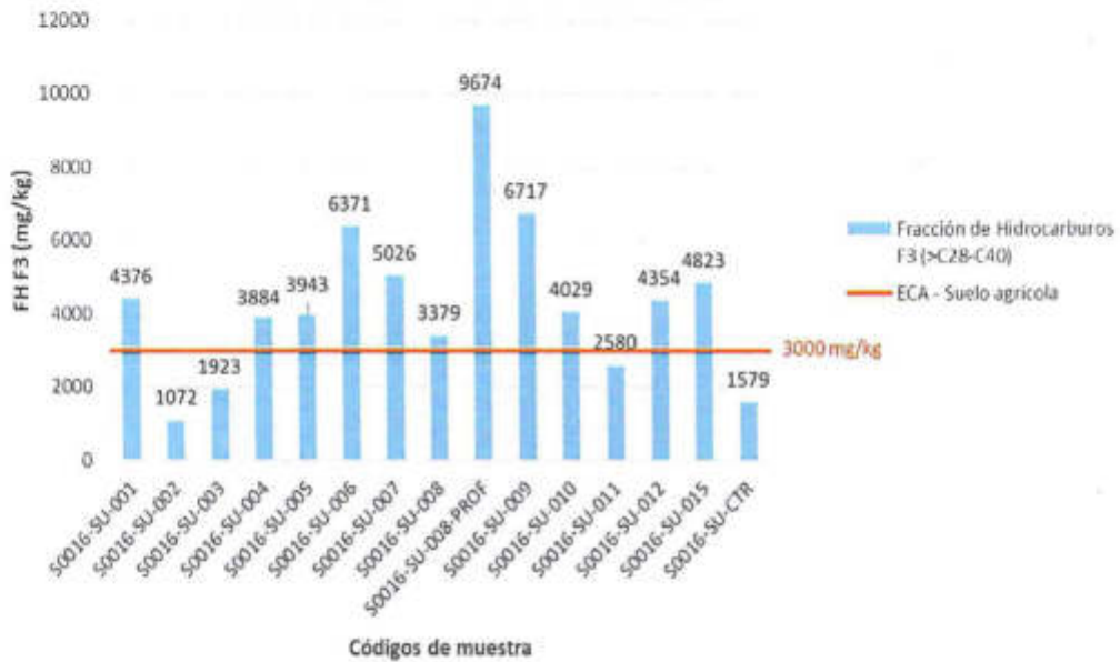
Figura 8- 1. Concentraciones de fracción de hidrocarburos F3 en el sitio S0016
