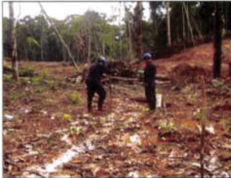
Foto 07: Realizando calicatas para la muestra M-02 en otro sector del área remediada.
