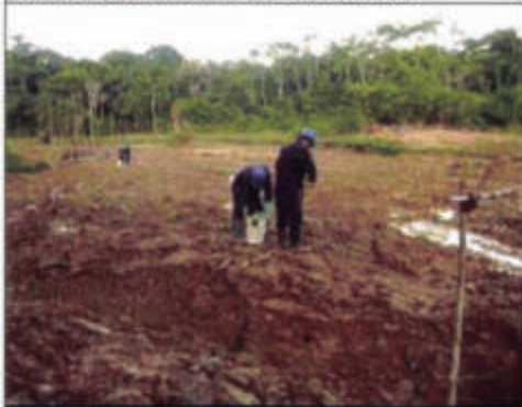
Foto 11: Realizando la homogenización y cuarteo de las muestras representativas para ser analizadas en laboratorio.
