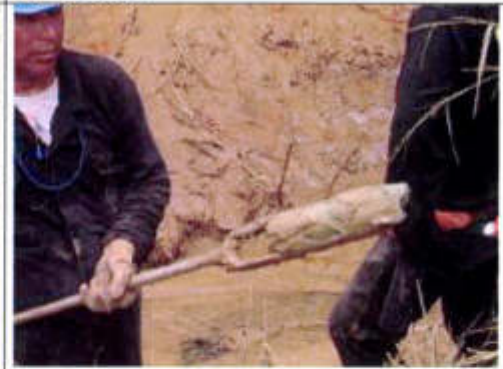
Foto 16: Muestra colectada en el sitio a remediar indicado en el PAC, la muestra no evidencia visualmente presencia de hidrocarburos.
