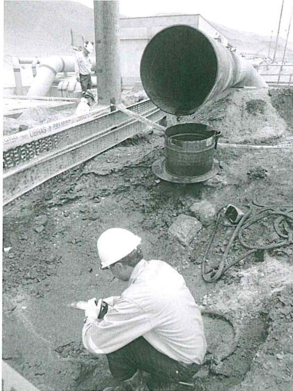
Fotografía N° 3. Mancha de Hidrocarburo entre los tanques 1D y 1E.
