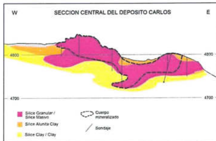
Figura 8-212. Perforaciones realizadas que ayudaron a la caracterización Lito-estructural y alteración del tajo Carlos. Fuente: EIA-Absoluciones a las observaciones efectuadas por Ministerio de energía y minas (volumen I), 2006.
