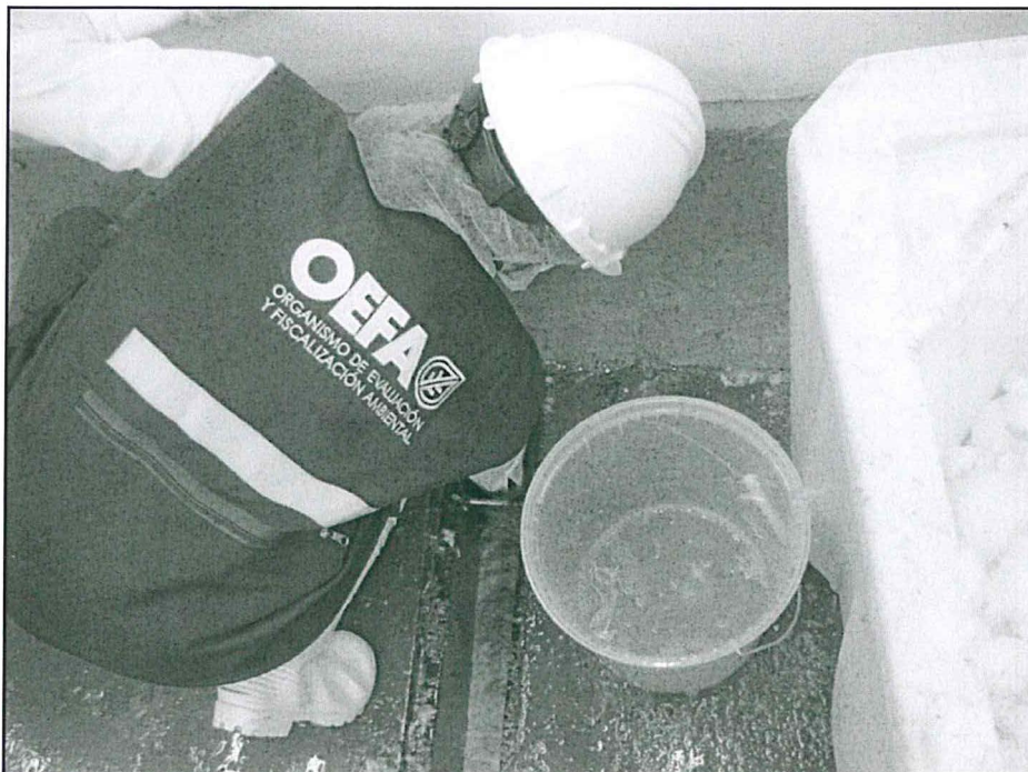
Fotografía N° 1. Punto de muestreo PAI-1, tomado al ingreso a la primera etapa de tratamiento físico de retención de sólidos.
