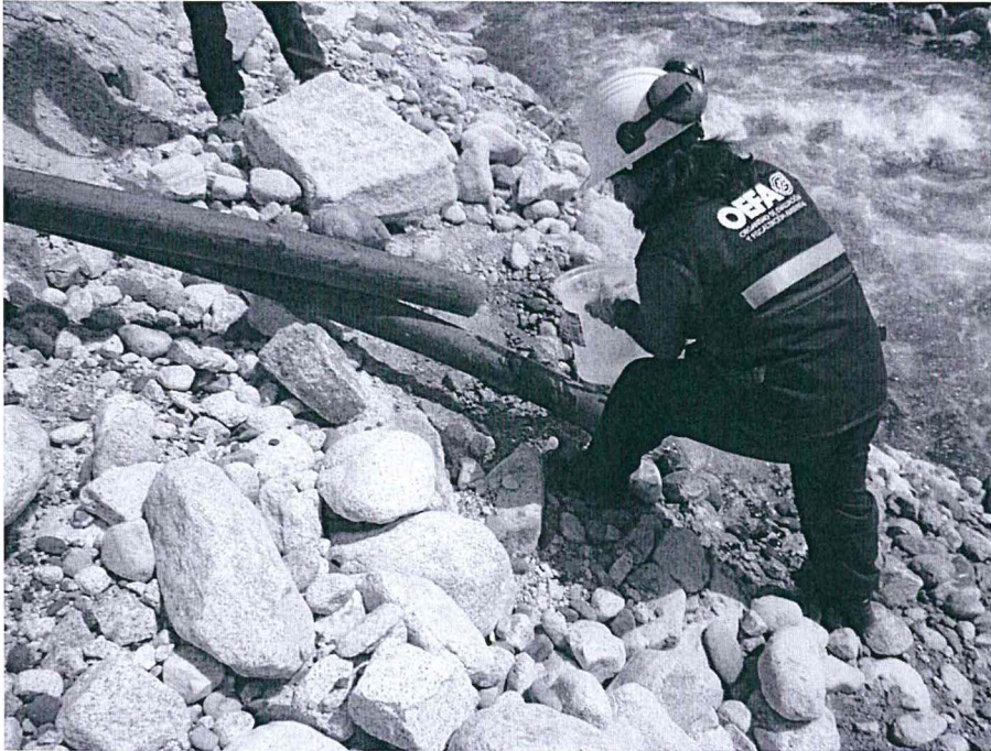
Fotografía 7. Toma de muestra de efluente en el punto de muestreo E-2 CH Quitaracsa, efluente que descarga en el río Quitaracsa, a 100 m del punto de muestreo E-1 CH Quitaracsa, antes de la confluencia del río Quitaracsa con la quebrada San Mateo, empresa ENERSUR S.A., poblado Chapiringo.
