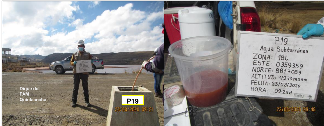
Figura 7.11. Piezómetro PZ-19 y muestra de agua con coloración rojiza con alta concentración de metales
