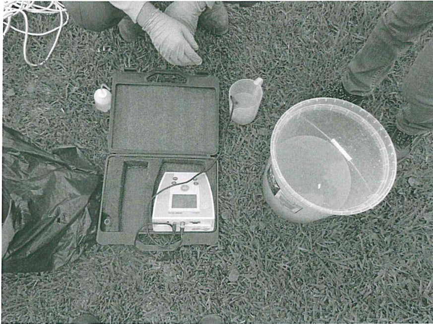
Fotografía N° 3: Medición de pH y T° del Punto EF-01P.
