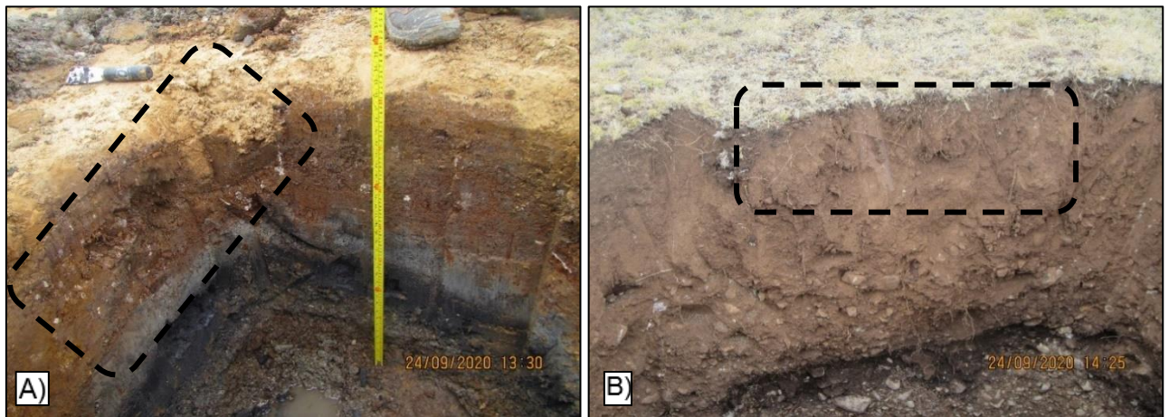
Figura 7.101. Diferencia de horizontes de suelos en: A) calicata API DR con presencia de material de color anaranjado con elevadas concentraciones de metales en referencia a los valores de los ECA para suelo 2017, uso agrícola, y B) calicata nivel de fondo sin presencia del material anaranjado y con concentraciones bajas en referencia a los valores de los ECA para suelo 2017, uso agrícola
