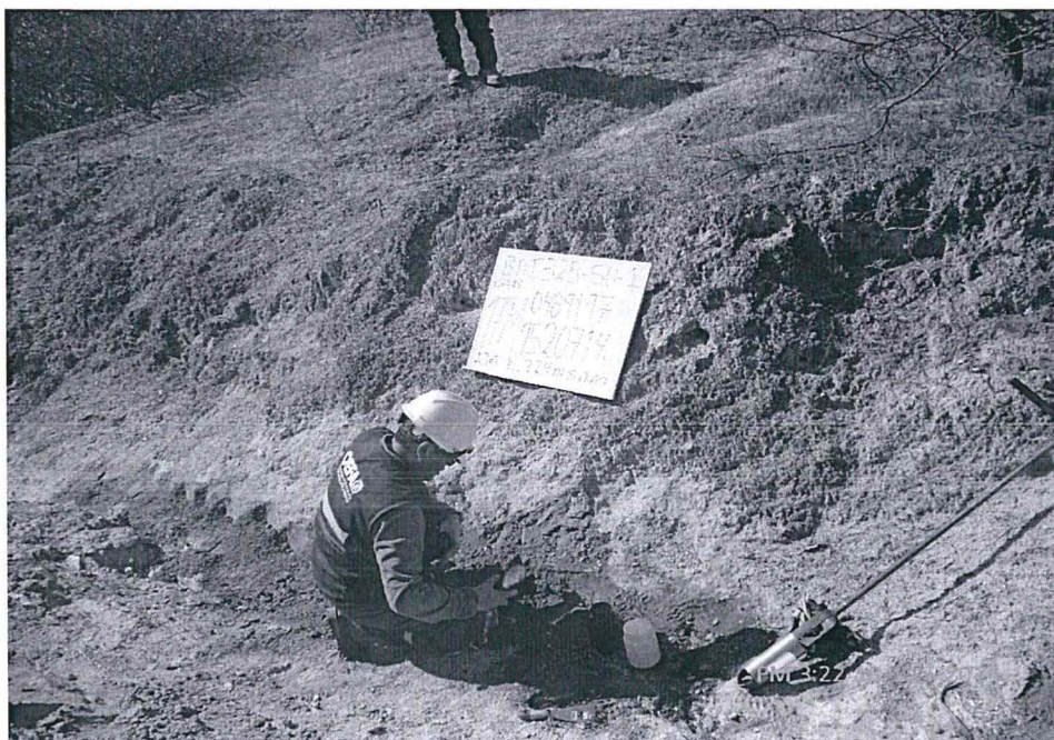
Fotografía N° 4 Punto de muestreo de suelo BAT 325-SU-1, mediante calicata de 0,30 metros de Profundidad.
