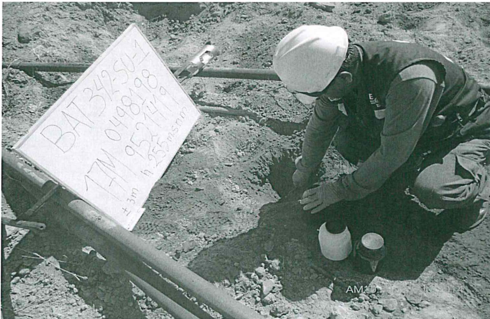
Fotografía N° 2. Punto de muestreo de suelo BAT 342-SU-1, mediante calicata de 0,30 metros de Profundidad.
