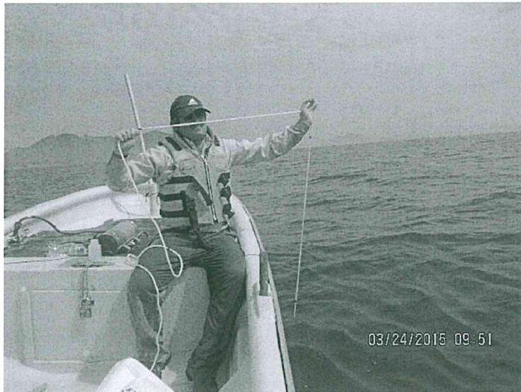
Fotografía N° 1. Medición de transparencia del agua con el disco Secchi (OEFA, 2015).
