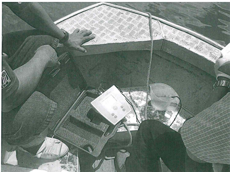
Fotografía N° 4. Medición de parámetros de campo en el río Itaya
