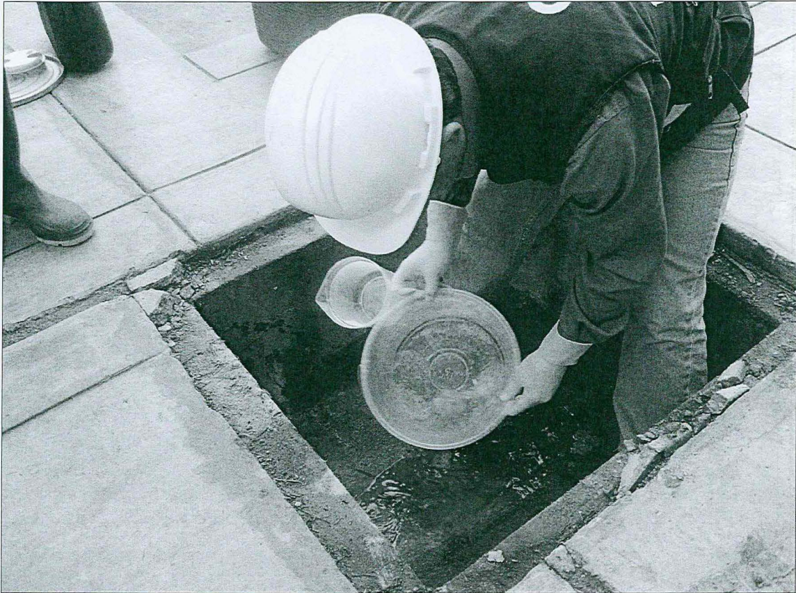
Fotografía N° 1. Caja de paso N° 1, efluente generado en la sala de procesos.
