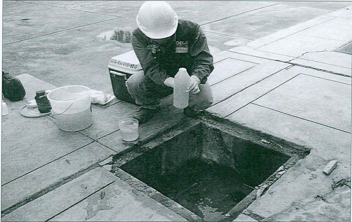
Fotografía N°4. Caja de paso N°1, toma de muestras del efluente de proceso y limpieza
