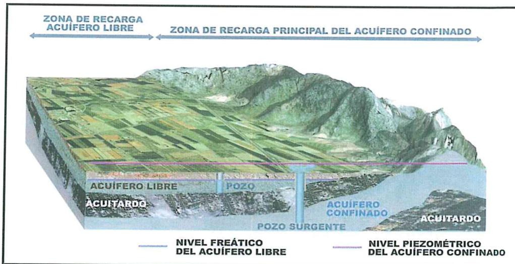
Figura 6- 3. Sistema hidrogeológico, donde se identifican las unidades hidrogeológicas (IGME en Sulca, 2010)
