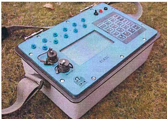
Figura 7- 6. Receptor EIREC PRO de 10 canales
