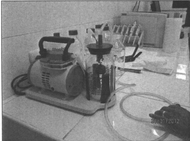
Foto N° 17 . Equipo de filtración al vacío.
