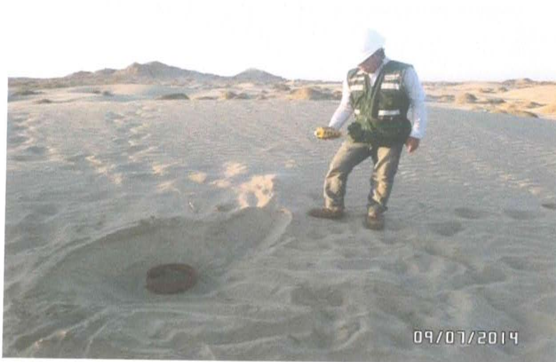
Fotografía N° 4. Mediciones en el F00448-VA01, se realizó en un recorrido en el área circundante alrededor del Pozo T2182 en un radio de 1 m, con una duración de 10 minutos.
