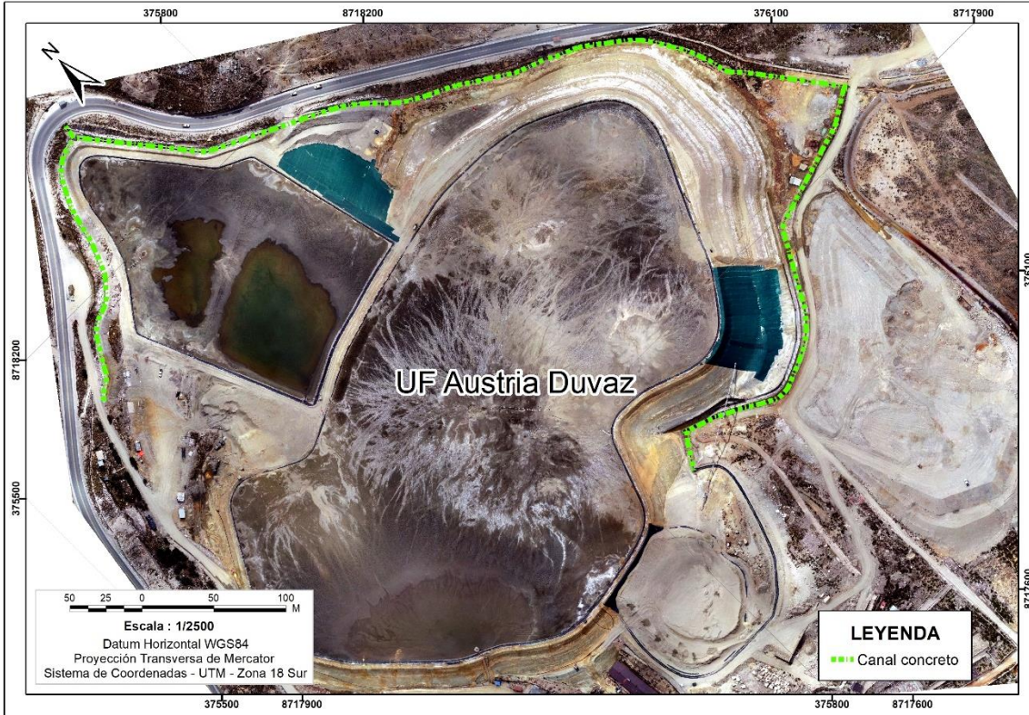
Figura 6.5. Canales de concreto en la zona Componentes de la UF Austria Duvaz
