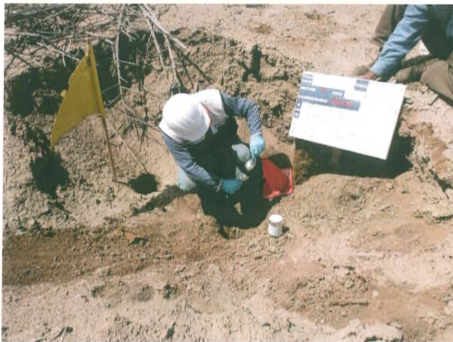
Fotografía N° 4. Muestra de suelo dentro del hoyo donde se encuentra el pozo.
