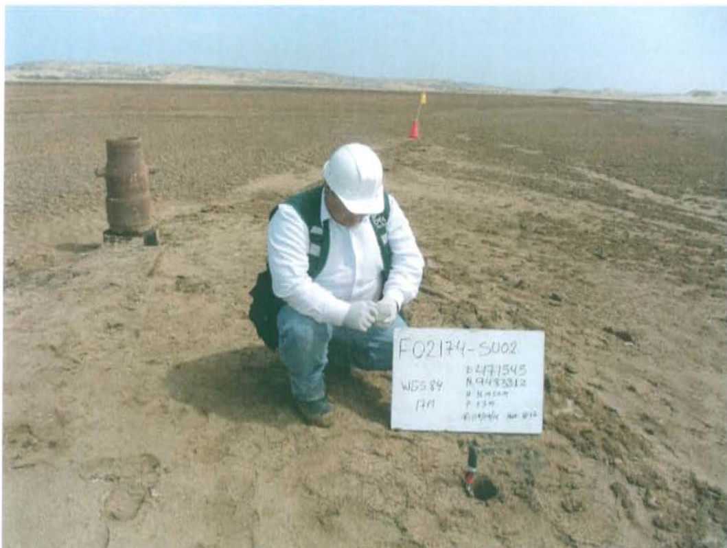
Fotografía N° 4. Toma de muestra de suelo en el punto F02174-SU02, ubicado a 3 m aproximadamente, al sureste del Pozo T1742
