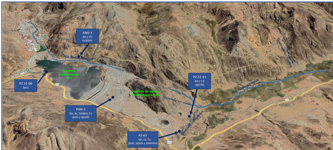
Figura 5.10. Ubicación de los puntos de monitoreo de agua subterránea y parámetros que superaron los ECA para Agua 2017 Categoría 3.
