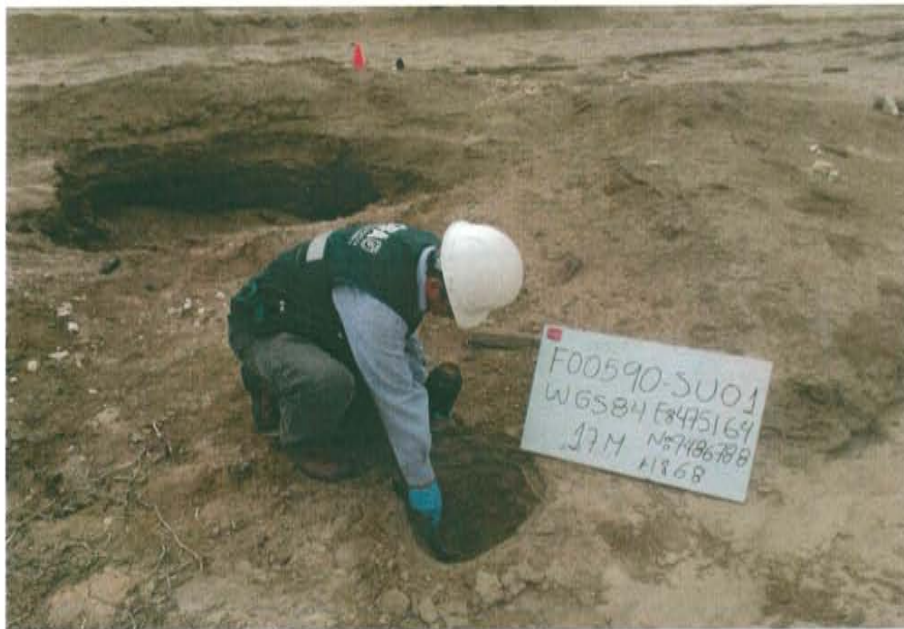
Fotografía N° 4. Toma de muestra de suelo en el punto F00590-SU01 a 3 m. de la ubicación del pozo.
