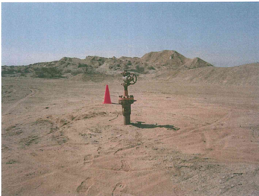
Fotografía N° 1. Pozo inactivo ubicado en un terreno habilitado posee cabezal con visibles signos de corrosión en la base.
