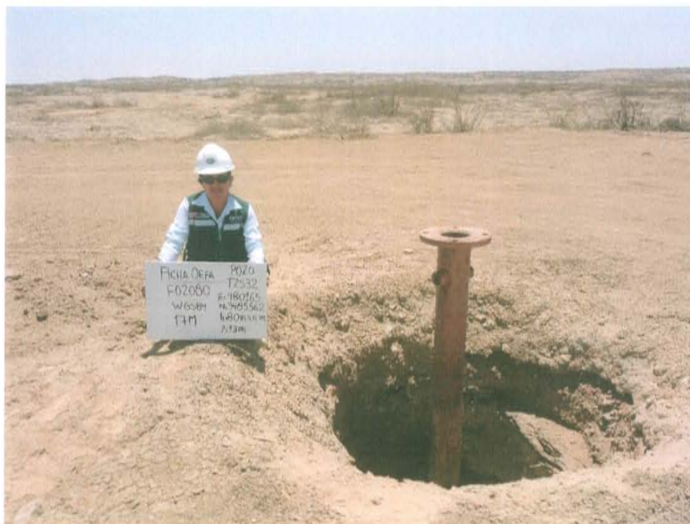
Fotografía N° 1. Identificación del pozo inactivo con código PERUPETRO T2532. Presenta casing con tapa de brida adaptadora con salidas laterales, descubiertas en el interior de una excavación y expuestas a la intemperie.
