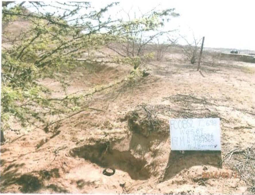
Fotografía N° 1. Se observa casing de superficie de 10 plg de diámetro y tubería de producción de 2 ½ plg de diámetro abiertos.
