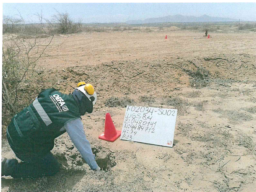
Fotografía N° 4. Toma de muestra de suelo en el punto F02034-SU02, ubicado a 9 m aproximadamente del Pozo T3171.
