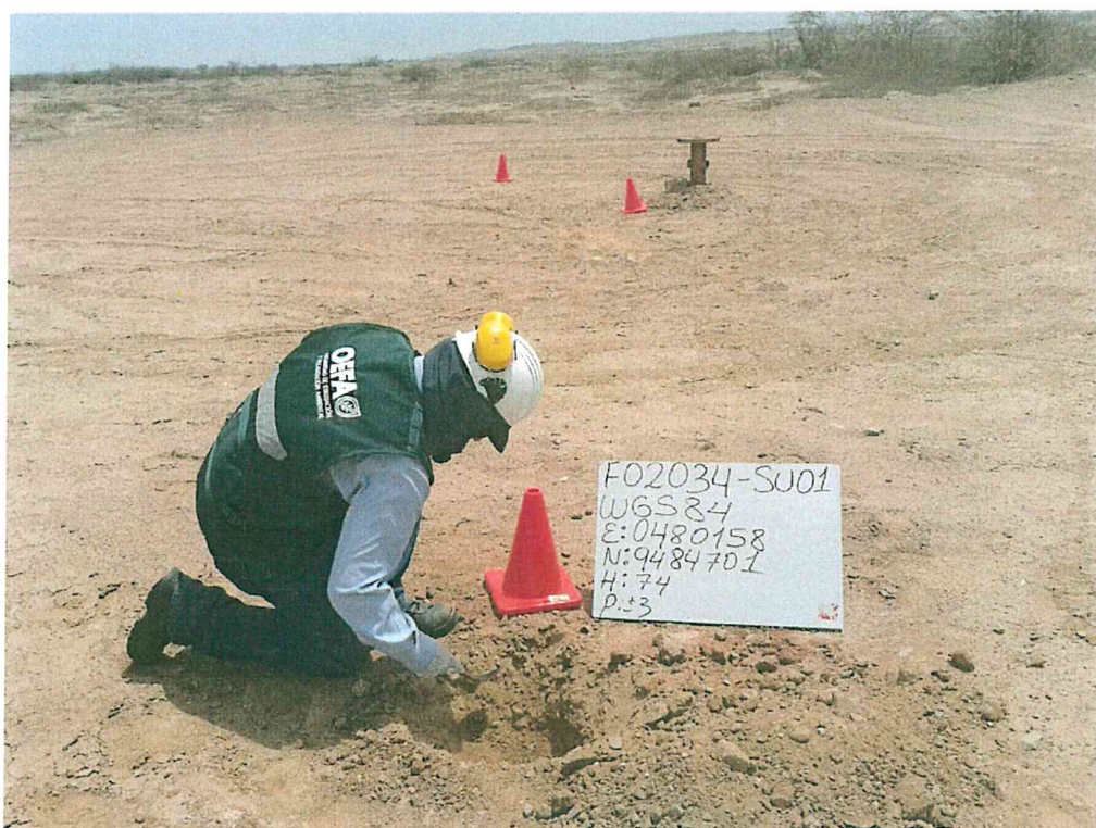
Fotografía N° 3. Toma de muestra de suelo en el punto F02034-SU01, ubicado a 3,5 m aproximadamente del Pozo T3171.
