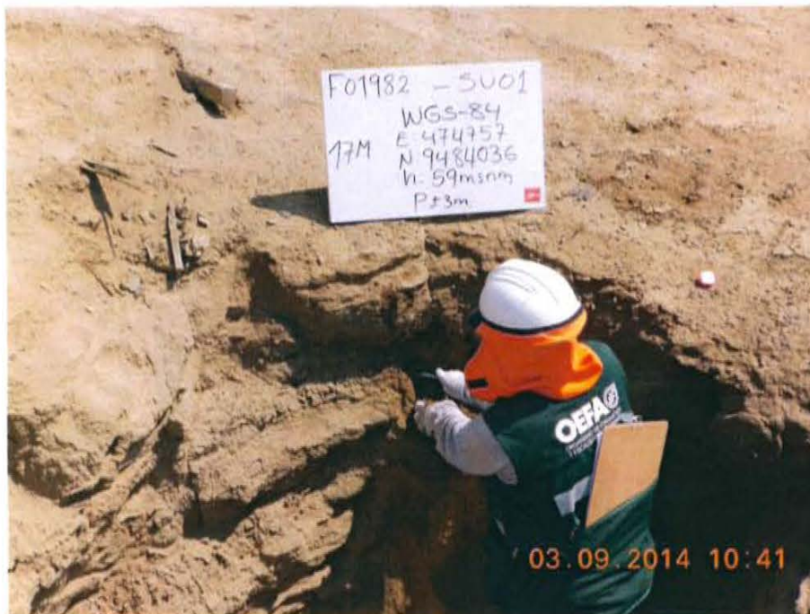
Fotografía N° 3. Toma de muestra de suelo en el punto F01982-SU01, ubicado a 0,9 m del Pozo T1895.
