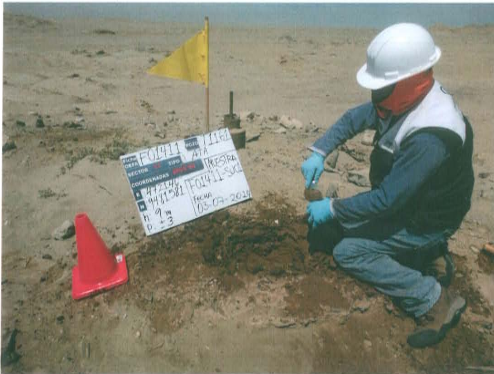
Fotografía N° 3. Toma de muestra de suelo en el punto F01411-SU01, ubicado a 1,8 m del Pozo T1161.
