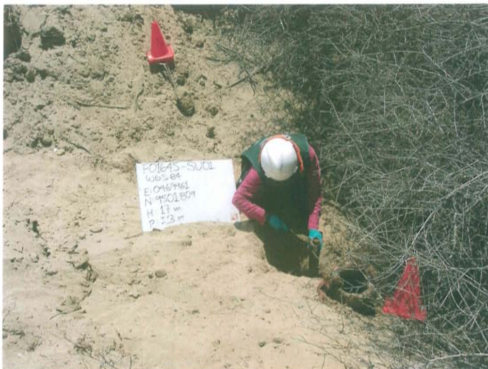
Fotografía N° 3. Recojo de la primera muestra de suelo F01645-SU01 a 0,3 m de distancia del pozo.
