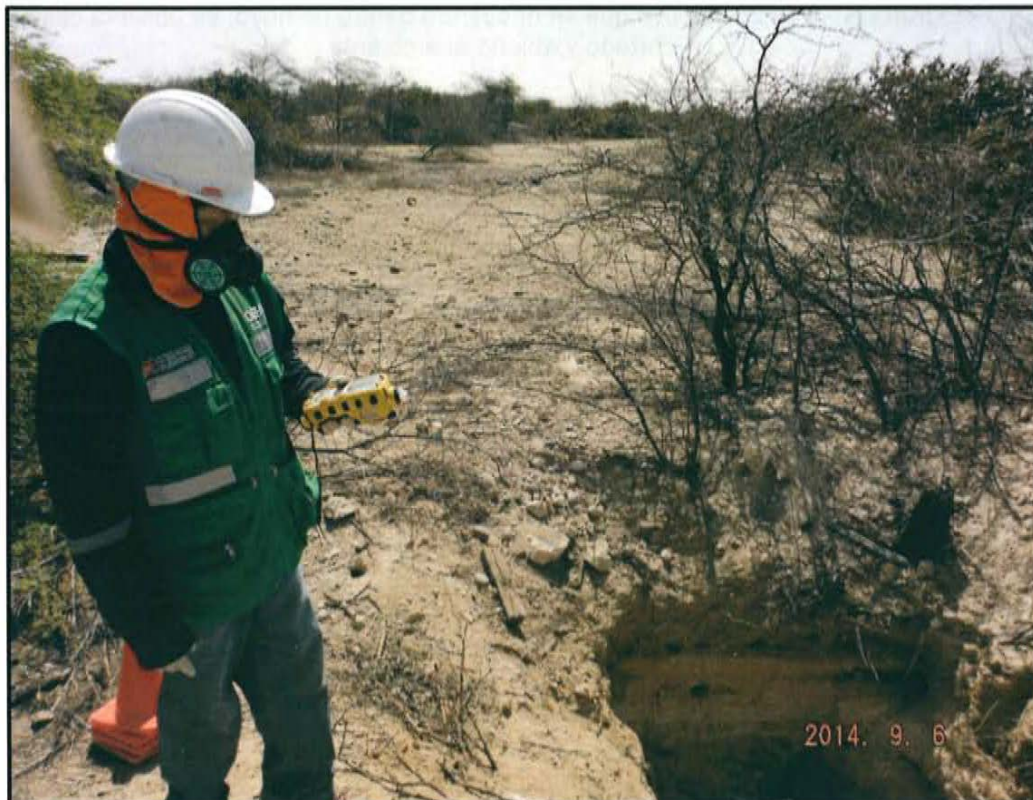
Fotografía N° 4. Medición de emisiones fugitivas provenientes del pozo T4095.
