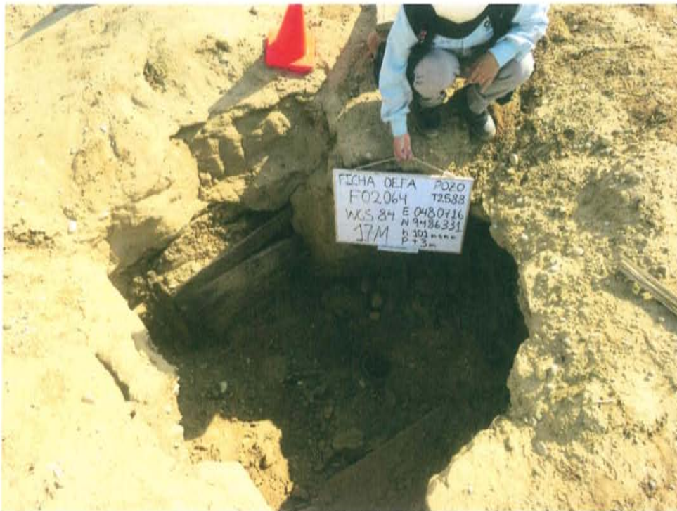
Fotografía N° 2. Dentro del hoyo se encontró un casing con tubing cortado y restos de madera correspondiente en los bordes.
