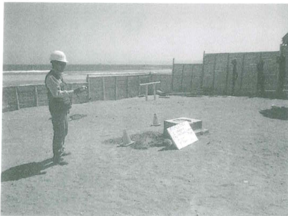
Fotografía N° 2. Mediciones en el punto F01911-VA01, se realizó en un recorrido en el área circundante alrededor del Pozo L_334 en un radio de 1 m.
