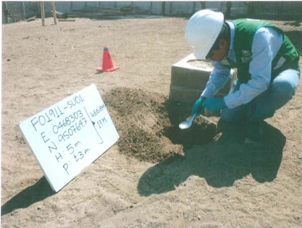
Fotografía N° 3. Toma de muestra de suelo en el punto F01911-SU01, ubicado aproximadamente a 0,5 m al oeste del Pozo L_334.
