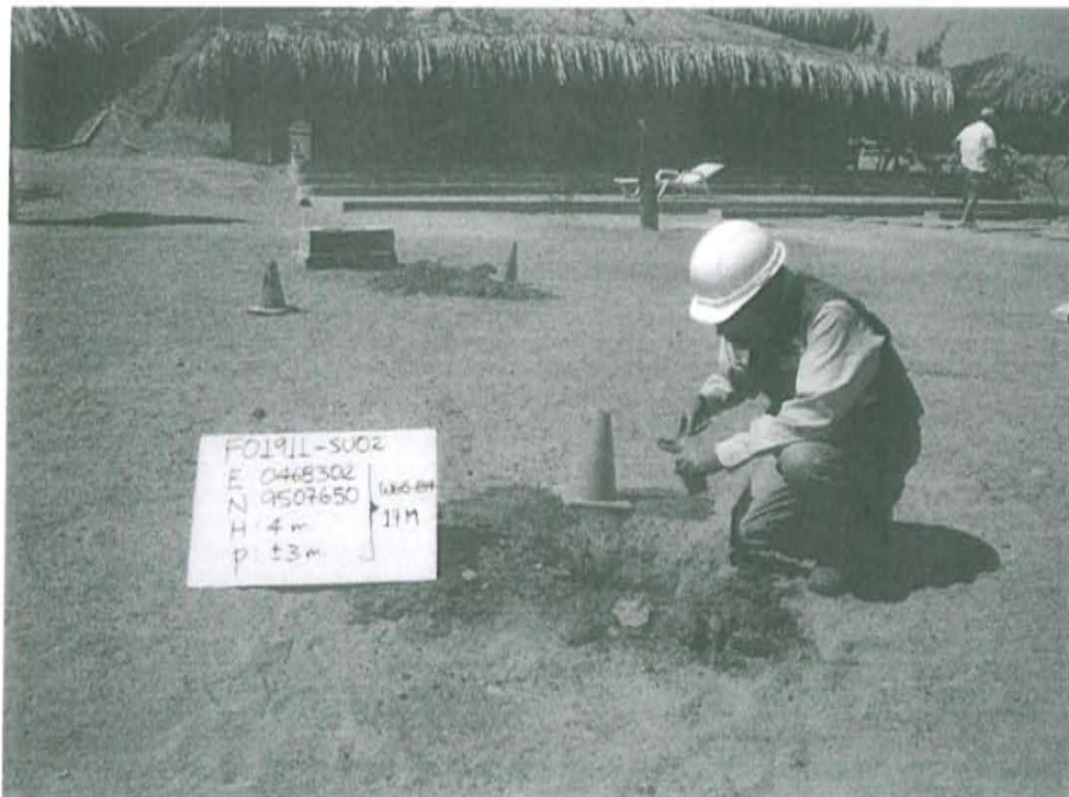
Fotografía N° 2. Toma de muestra de suelo en el punto F01911-SU02 ubicado a 5 m al norte del Pozo L_334.
