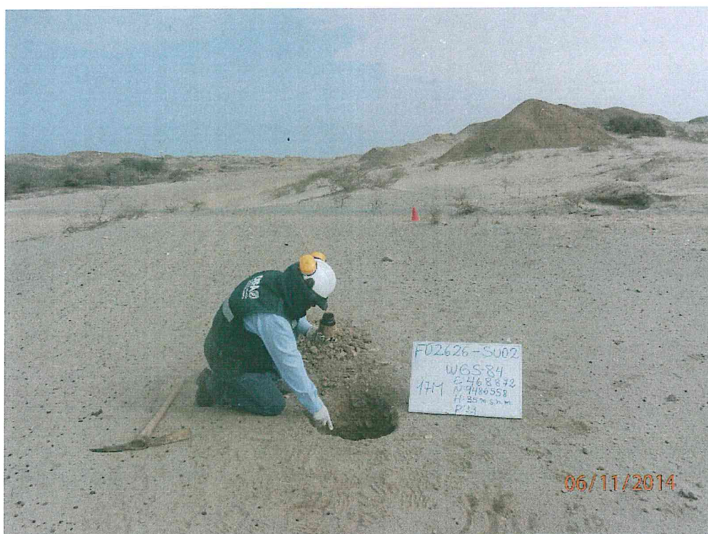
Fotografía N° 4. Toma de muestra de suelo en el punto F02626-SU02, ubicado a 12 m aproximadamente del Pozo T4827.
