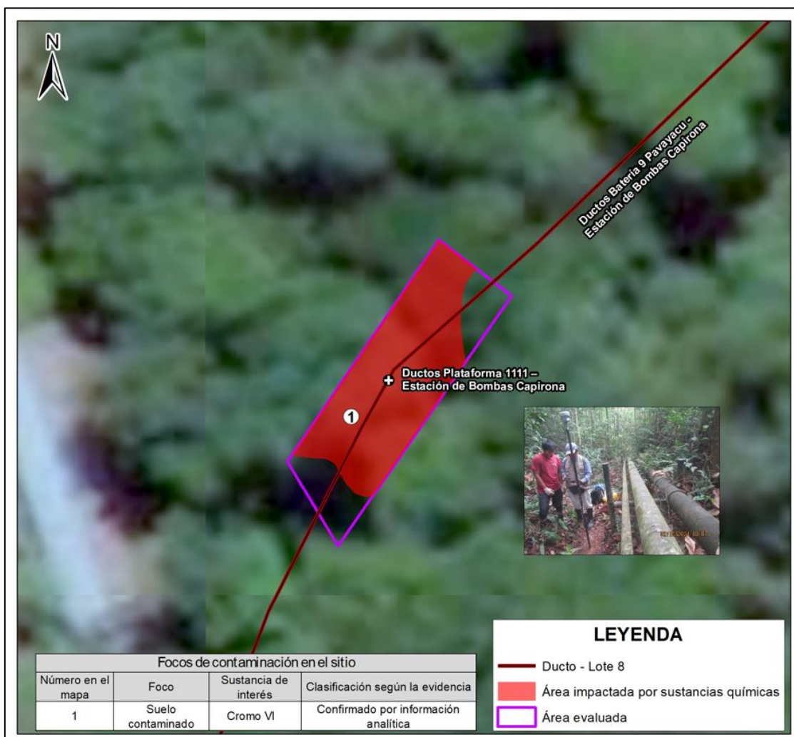
Figura 8.4. Fuentes y focos potenciales de contaminación para el sitio S0555
