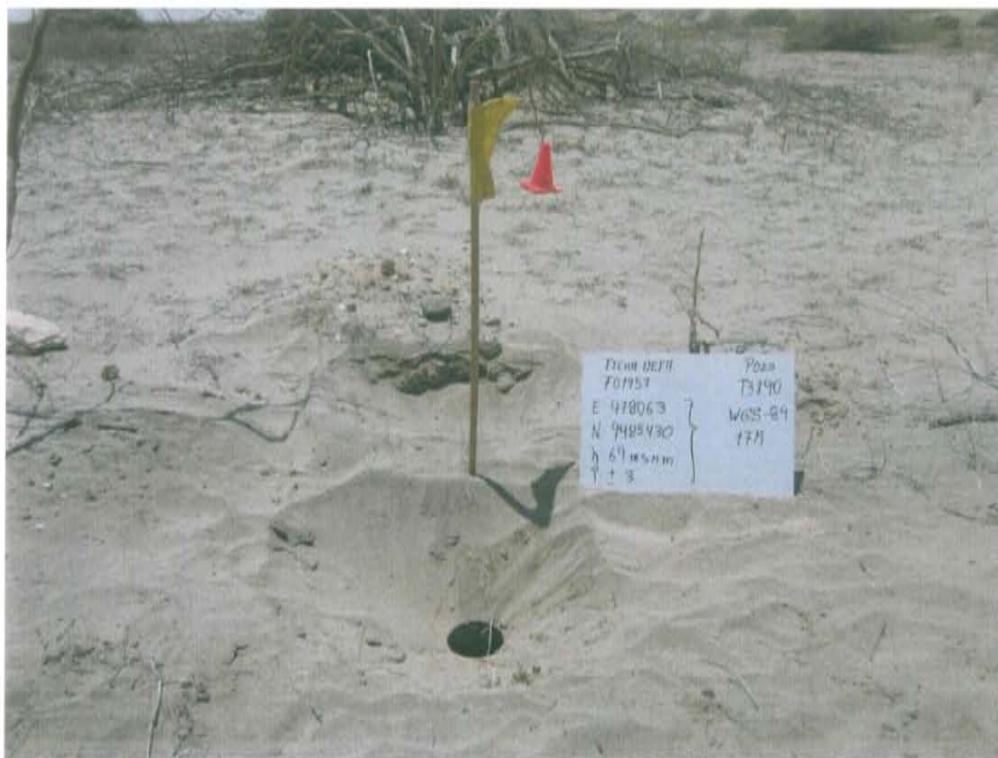
Fotografía N° 1. Se observa el casing descubierto a nivel de superficie de suelo correspondiente al pozo inactivo con código PERUPETRO T3190.
