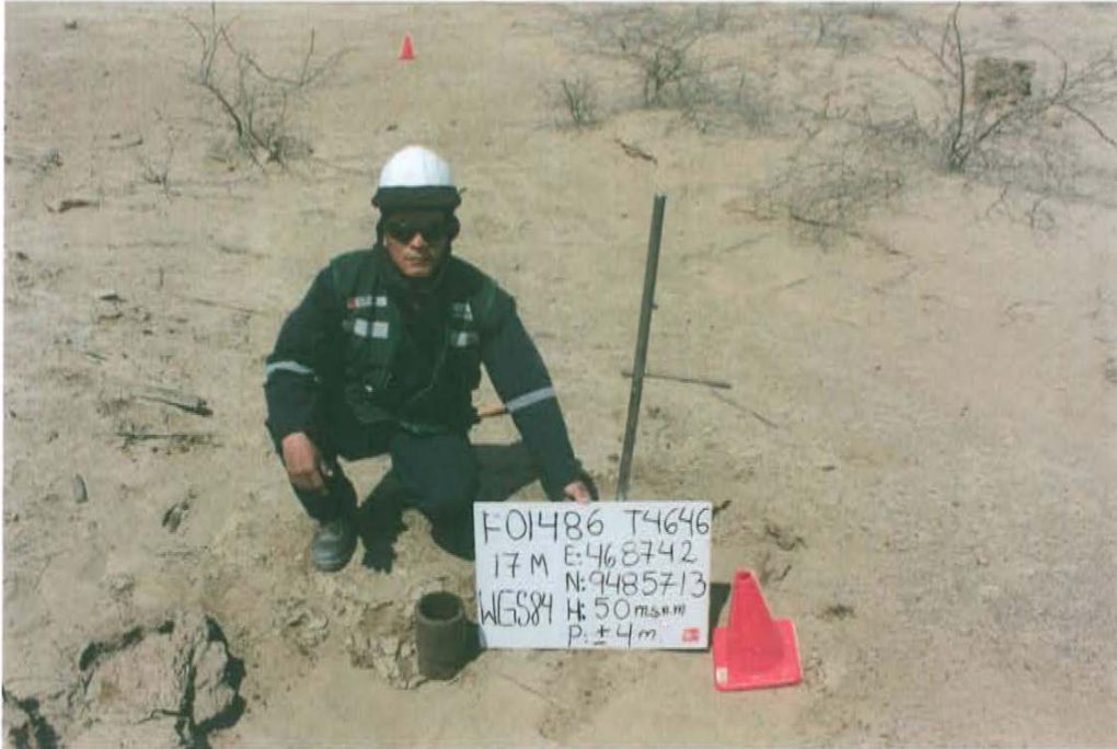
Fotografía N° 1. Pozo T4646, presenta casing de aproximadamente 5 pulgadas de diámetro cortado y corroído.
