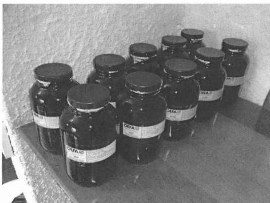
Fotografía 9-a. Frascos de vidrio ámbar conteniendo muestras de agua superficial y suelo antes de ser depositados en cooler para traslado a laboratorio.
