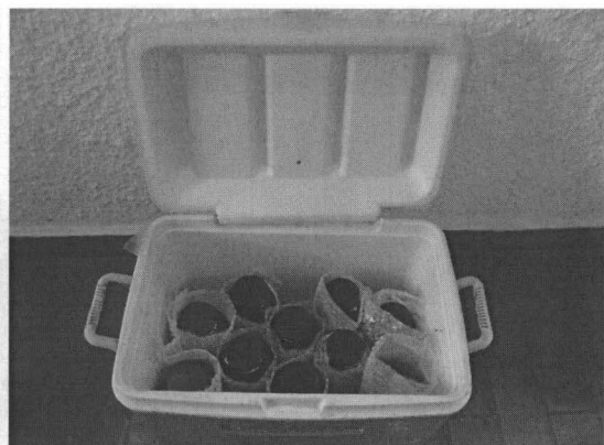
Fotografía 9-b. Frascos con muestras de agua superficial y suelo debidamente acondicionadas para transporte en cadena de frío y preservación de integridad de frascos.
