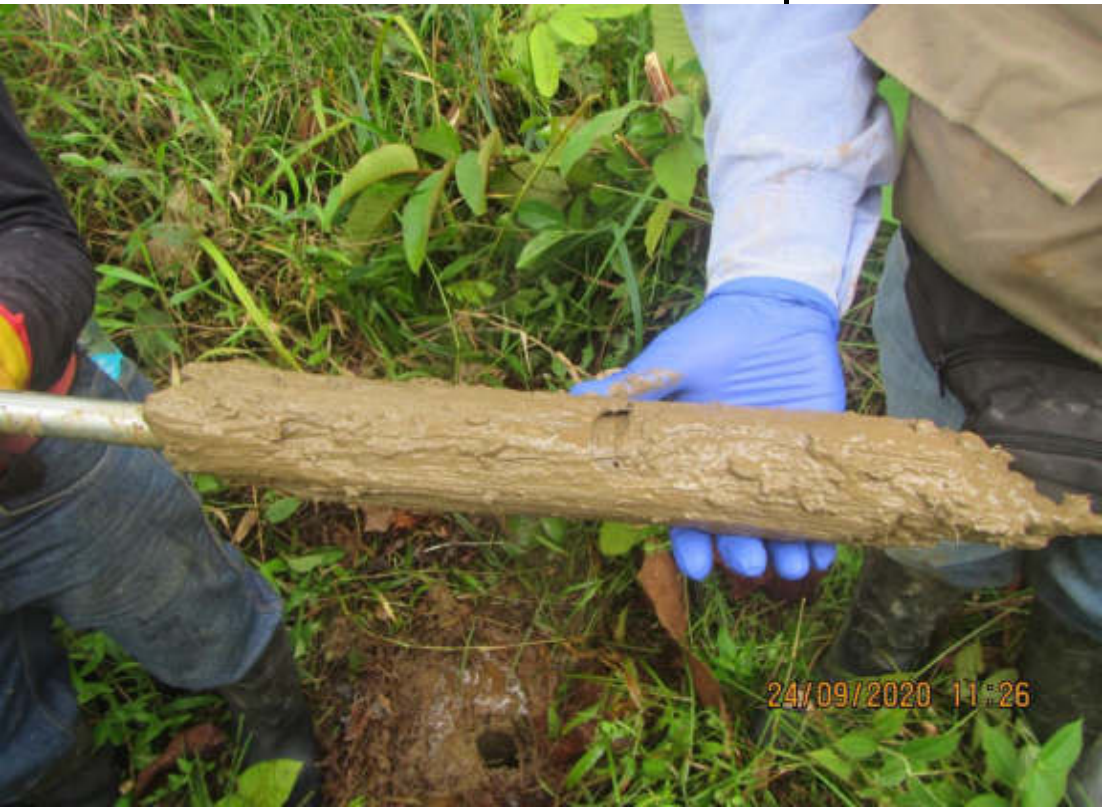
Suelo arcilloso - arenoso, saturado de color marrón, con materia orgánica superficial.
