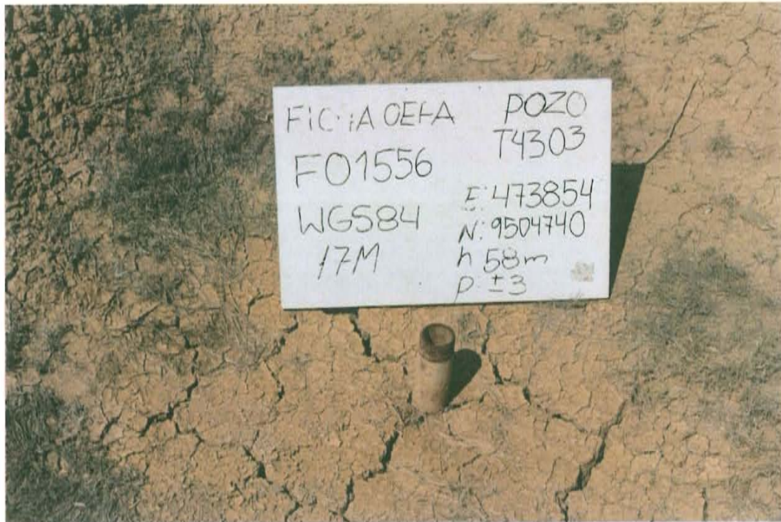
Fotografía N° 1. Identificación del pozo inactivo con código PERUPETRO T4303. Presenta tubo de aproximadamente 2 plg de diámetro descubierto en el fondo de una excavación.
