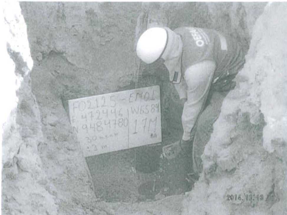
Fotografía N° 1 Medición en el punto F02125-EM01, ubicado en la fuente de emisión en boca del Pozo T2179
