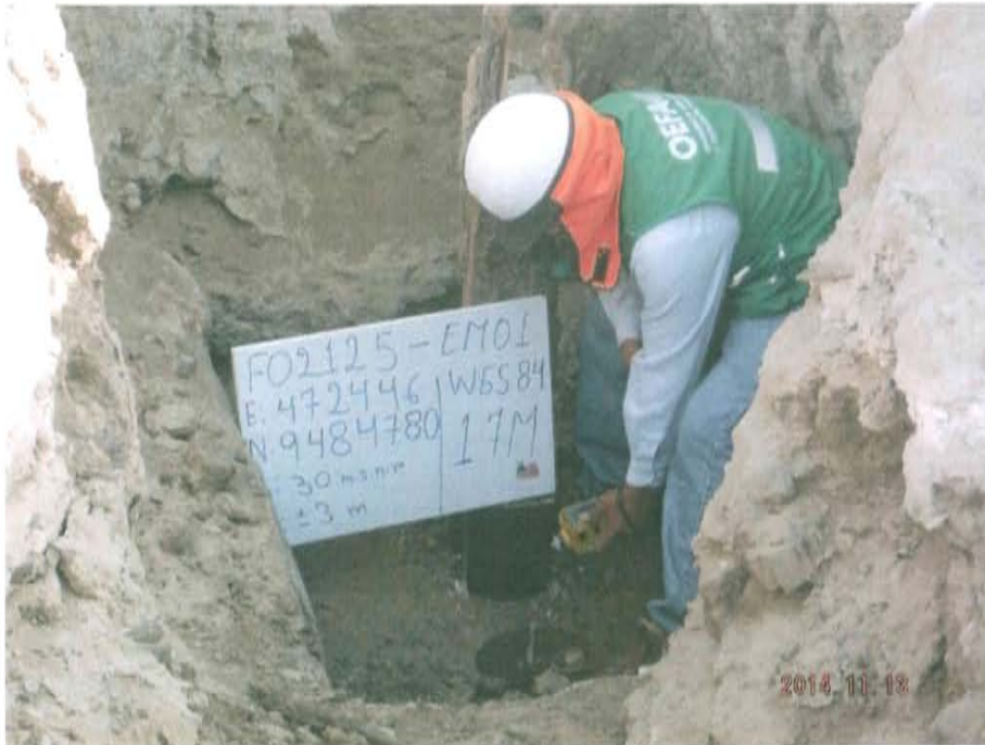
Fotografía N° 4. Vista de la evaluación de emisiones gaseosas a boca de pozo F02125.
