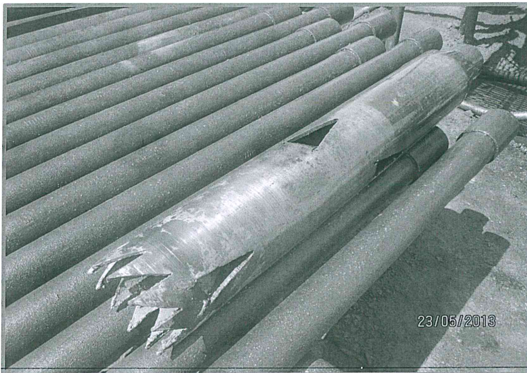
Foto 5: Canasta dentada con espigas interiores, empleada para recuperar material.
