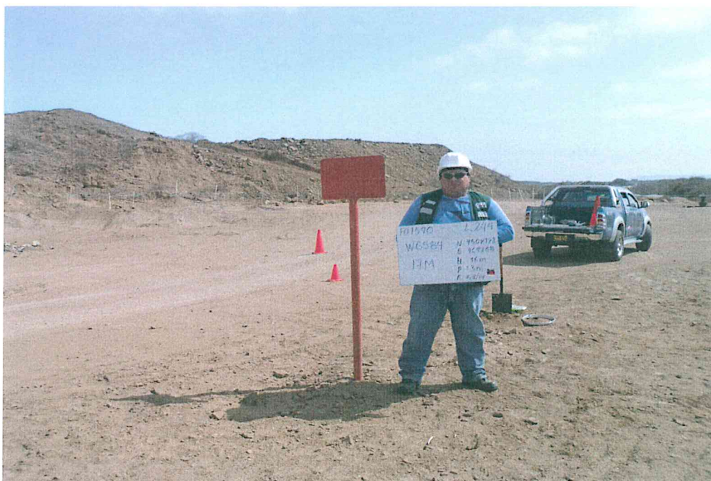
Fotografía N° 2. La altura de la varilla de acero es de 1,5 m en relación a la superficie del terraplén, la loza de cemento se encuentra enterrada y no hay cantina.
