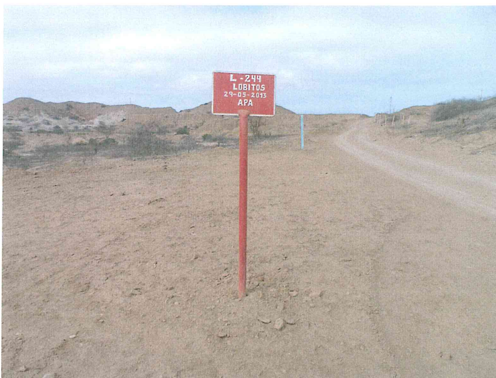
Fotografía N° 1. Pozo petrolero que fue priorizado para abandono de acuerdo a la Ley N° 28880. Con varilla y letrero de identificación donde indica la fecha de abandono el 29 mayo del 2013.
