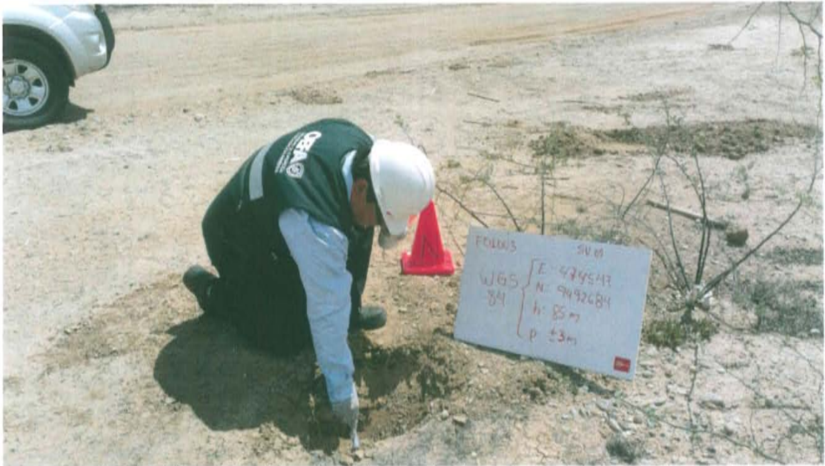
Fotografía N° 3. Vista de la obtención de la muestra de suelo en el área de ubicación del pozo en el punto F01003-SU01.
