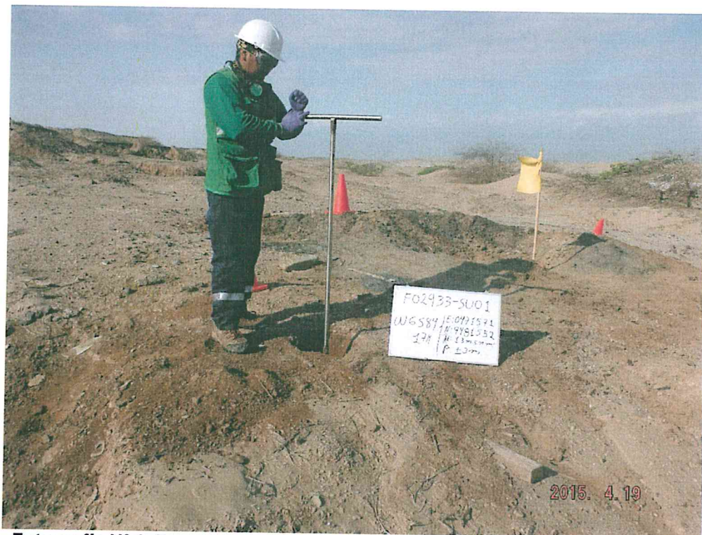
Fotografía N° 3. Toma de muestra de suelo en el punto F02933-SU01, ubicado a 3 m con dirección oeste del Pozo T1056.
